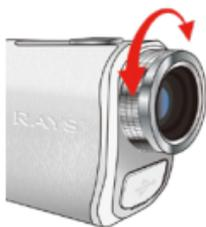
見えにくい場合は、焦点調節リングを回して調整してください。
