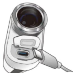
本体の電源カバーをめくり、USB ポートに充電ケーブルの USB Type-C 端子 (小さい方) を差し込みます。
